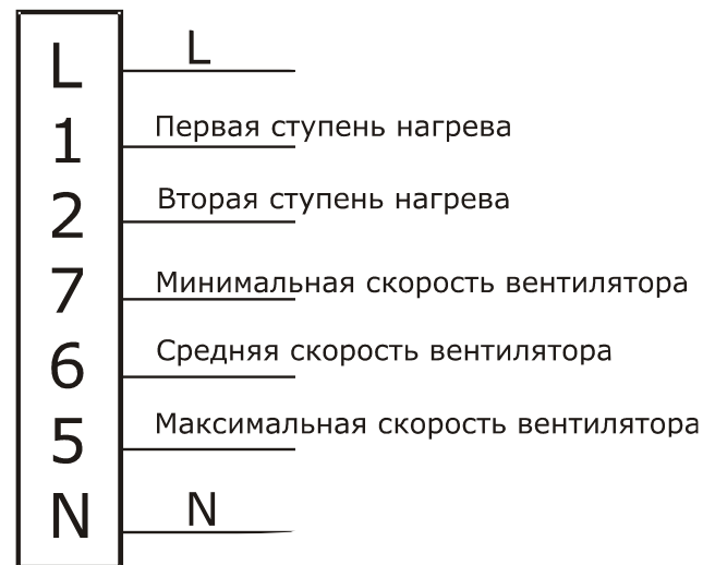
Рис. 7. Электрическая схема подключения пульта управления
